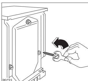
При помощи гаечного ключа удалите правый болт на задней стенке машины. Осторожно положите машину на заднюю стенку, стараясь не пережимать шланги. Проложите между машиной и полом пенопластовый упаковочный уголок.
