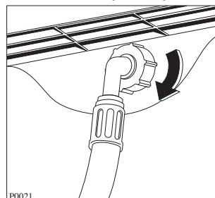
Присоединяемый к машине конец наливного шланга может поворачиваться в любую сторону. Ослабьте гайку, поверните шланг в нужном направлении и вновь затяните гайку.
