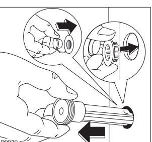
Выньте 3 пластмассовых стержня и закройте отверстия 3 пластмассовыми пробками, которые прилагаются к машине.
